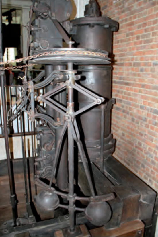
Figure 3. Ce régulateur est installé sur la célèbre machine à vapeur « Lap » de la société Boulton & Watt. Elle date de 1788 et se trouve actuellement au Science Museum à Londres.
