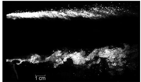
*L'image du haut montre un écoulement fluide supersonique relativement régulier. Dans l'image du bas, l'action d'un petit jet de fluide injecté latéralement a eu pour résultat le développement d'instabilités dans l'écoulement. Une telle manipulation illustre l'idée que l'on peut agir sur un écoulement à l'aide de petits dispositifs, notamment en vue de le contrôler (Clôché Erwan Collin-LEA/CEAT-Université de Poitiers).*
