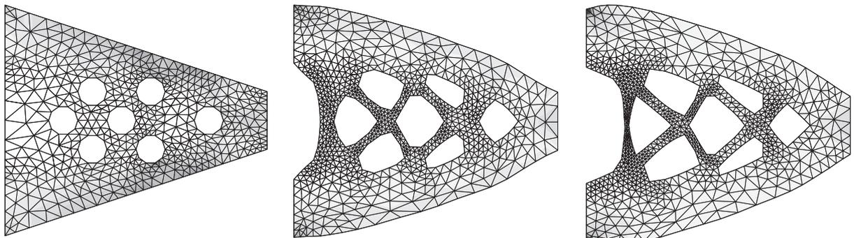
Figure 1. Initialisation (à gauche), itération intermédiaire (au centre) et forme optimale (à droite) d'une console, obtenues par la méthode d'Hadamard.
