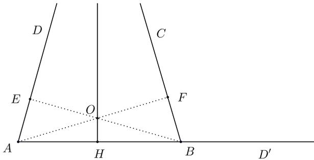
Figure 8. Construction de la perpendiculaire à une droite donnée parallèle à une autre droite donnée
