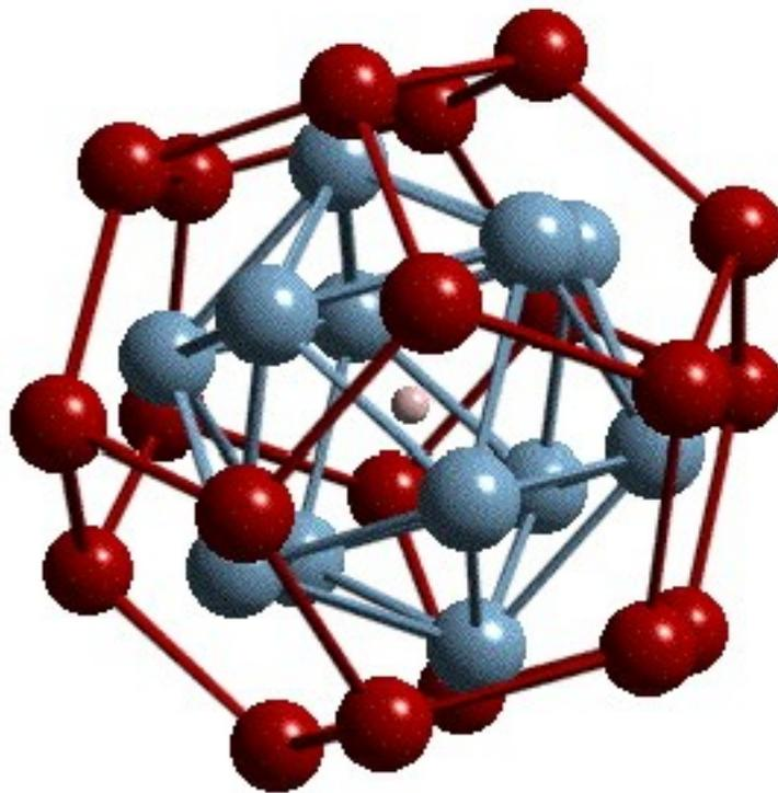
Ceci est l'un des deux amas de base du modèle KG (modèle dit "KG" pour Katz et Gratias). Il est constitué d'un atome au centre, un icosaèdre et un icosidodécaèdre soit  $1+12+20 = 33$  atomes.
