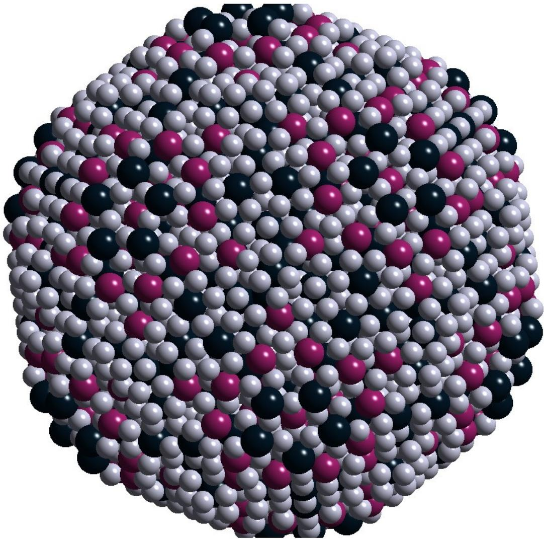
Ceci est l'une des vues selon les axes respectivement 2, 3 et 5 d'un modèle atomique de l'alliage Al-Pd-Mn.
