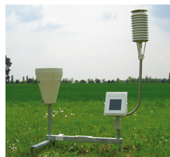
Une station Pulsia III : pluviomètre à gauche, sonde température dans son abri à droite. Crédit : Pulsonic.
