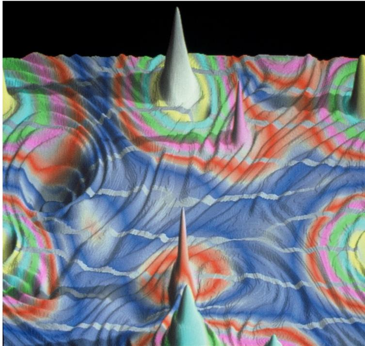
*Analyse continue en ondelette (de Morlet) d'un écoulement turbulent bidimensionnel calculé par simulation numérique. La visualisation superpose :*
