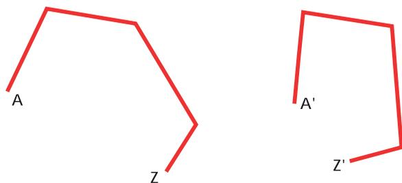
*Si l'on diminue les angles de la chaîne, la distance entre les extrémités diminue : AZ est plus grand que A'Z'.*
